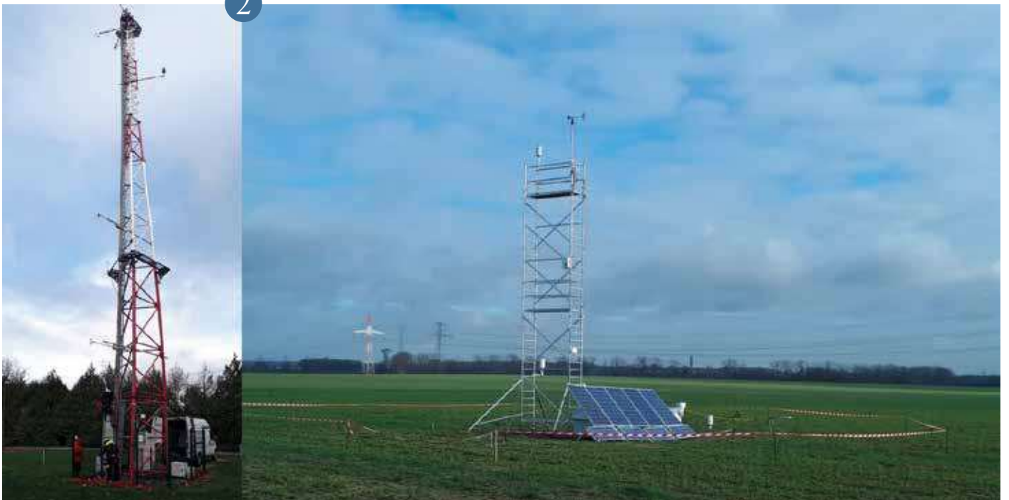
▲ Station de mesure du bilan d'énergie (gauche) sur un mat de 30m sur le site de Polytechnique, (droite) au milieu d'un champ agricole sur le plateau de Saclay.
