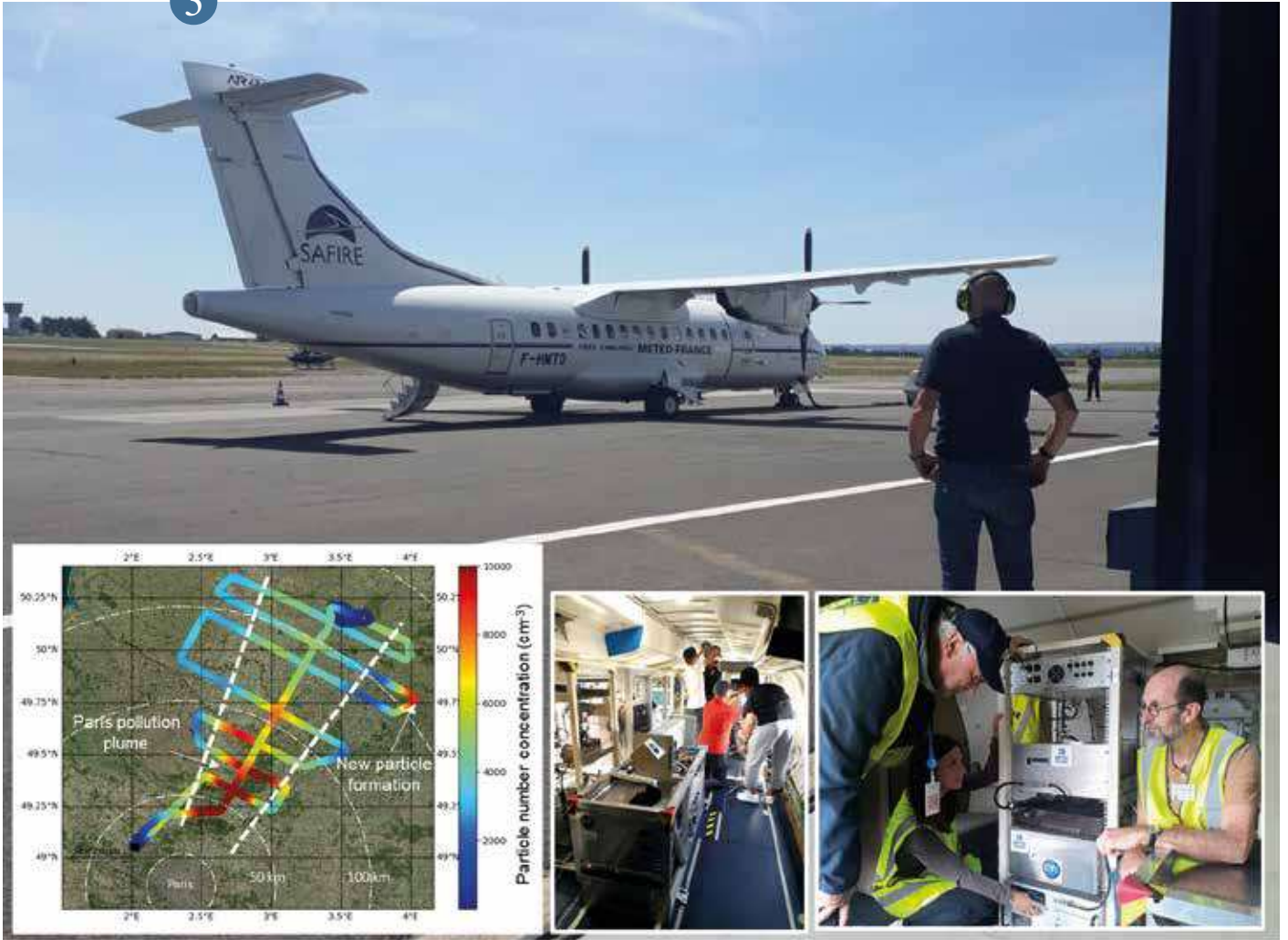
Figure principale : Préparation de l'avion de recherche ATR-42 de SAFIRE avant décollage. Figure en bas à gauche : Concentration en nombre de particules mesurées au cours d'un vol scientifique. Figure en bas au milieu : Préparation de l'instrumentation à bord de l'avion. En bas à droite : Calibration de l'HTDMA-SP2 nouvellement développé par le CNRM.
