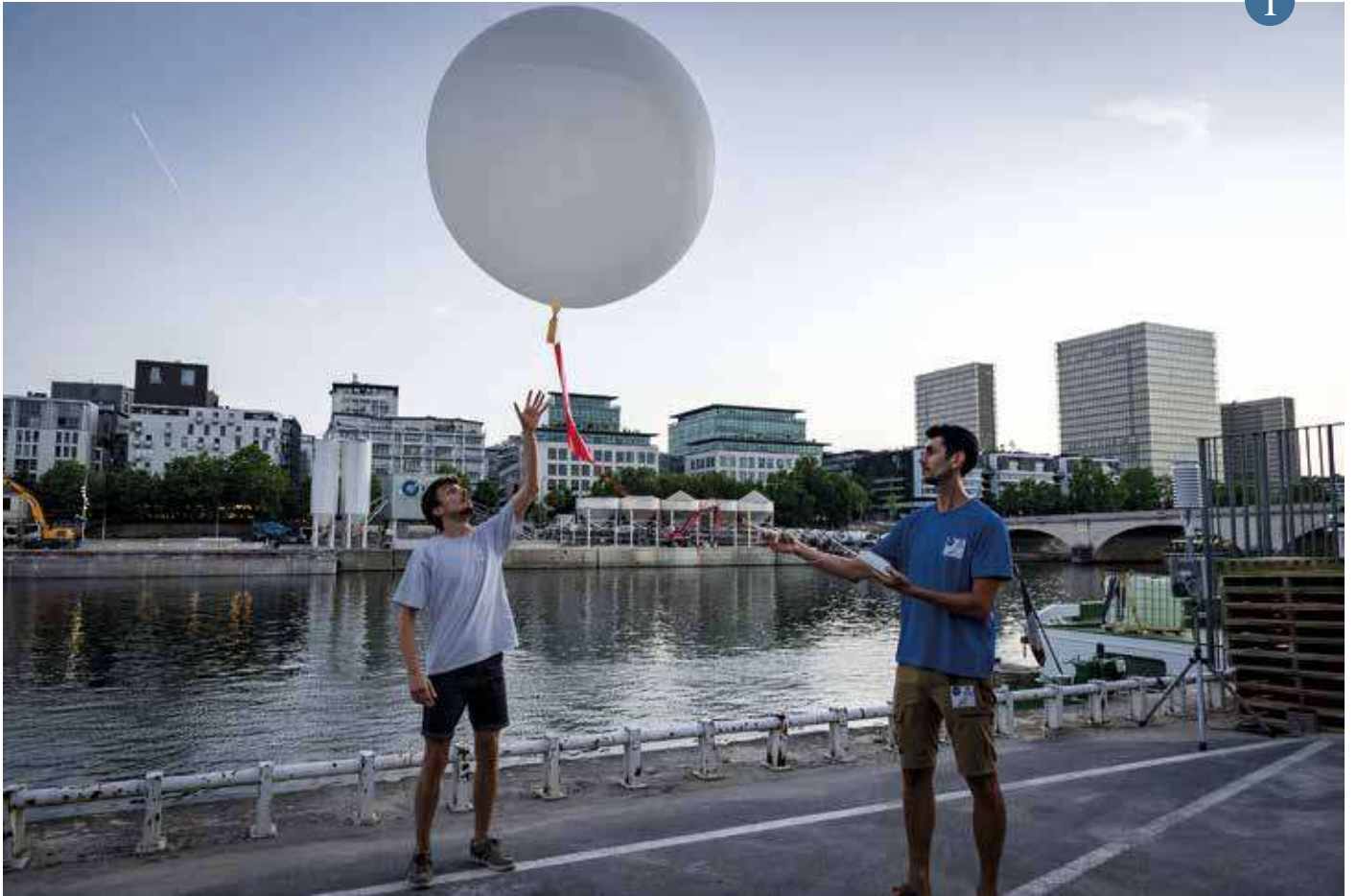
▲ Lancer de ballon météorologique pour observer la structure verticale de l'îlot de chaleur depuis les quais de Bercy (crédit photo : Cyril Frésillon, CNRS).
