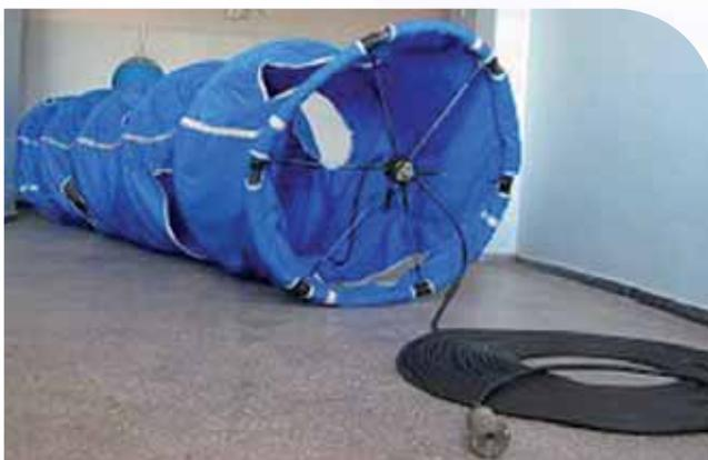
Chaîne bathythermique de mesure de la température de la mer jusqu'à 60 m de profondeur.
