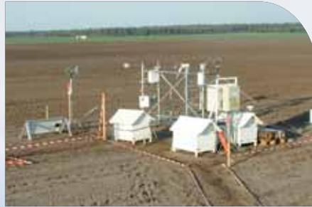
Station automatique de mesures du CNRM. Le centre de recherche dispose d'un ensemble de stations automatiques mobiles « projetables » n'importe où dans le monde dans le cadre de campagnes de mesures scientifiques internationales.
