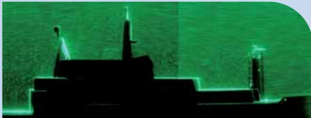
Vue de l'écoulement autour de la maquette de l'Atalante, dans la veine hydraulique du CNRM.
