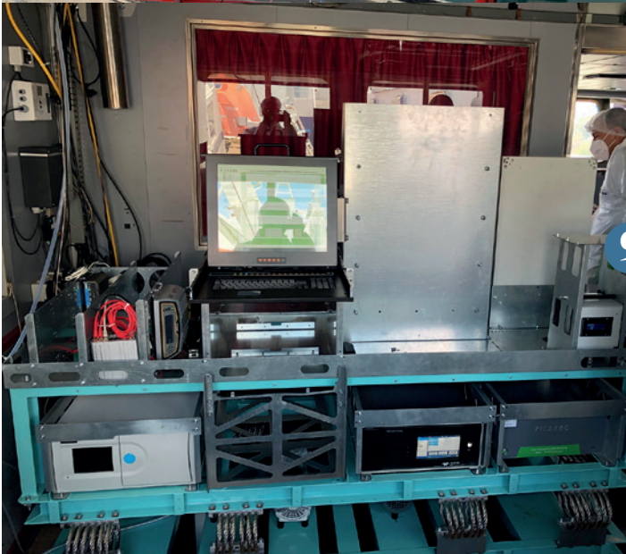
Station météo Vaisala Antenne du GPS Alloy, protégé par de la graisse Table amortissante de la salle météo
