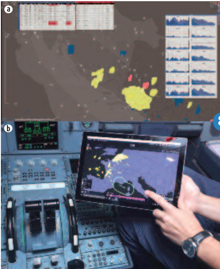
(a) : Exemple d'informations météorologiques (convection) visibles depuis le cockpit sur une tablette tactile (Copyright SESAR-TOPLINK-2016). (b) : Exemple d'informations météorologiques (convection) visibles depuis le poste FMP des Services de la Navigation Aérienne (copyright SESAR-TOPLINK-2016).
