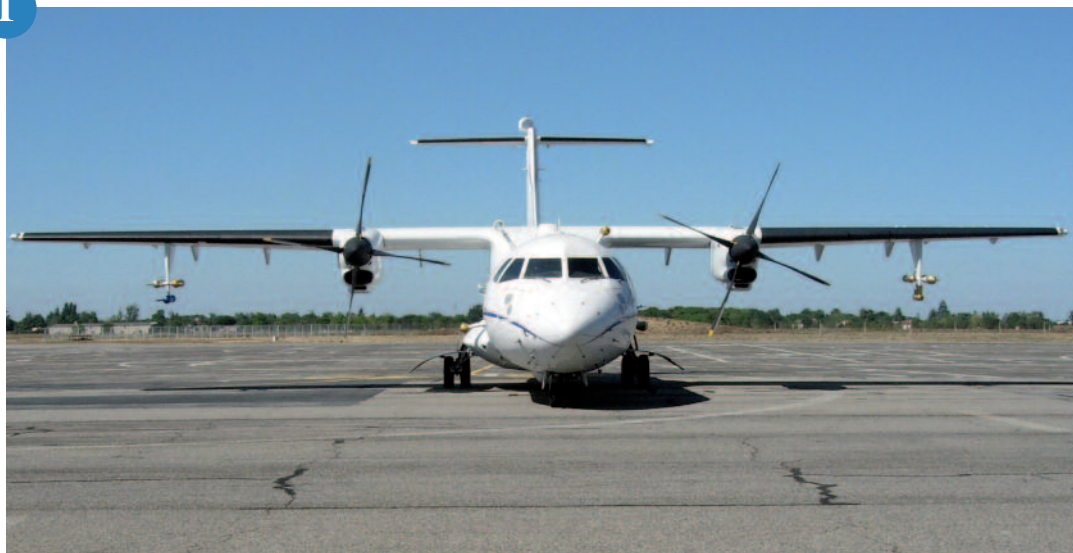
◀ L'ATR42 avec ses pylônes sous les ailes, équipés d'instruments d'analyse microphysique des nuages.
