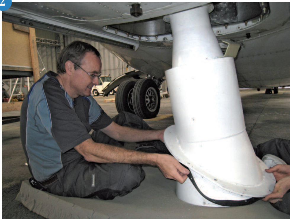
◀ Les équipes de SAFIRE installent l'antenne arrière du radiomètre CAROLS dans l'ouverture sous le fuselage de l'ATR42. (On voit ici Michel Cluzeau, technicien de l'équipe instrumentation)
