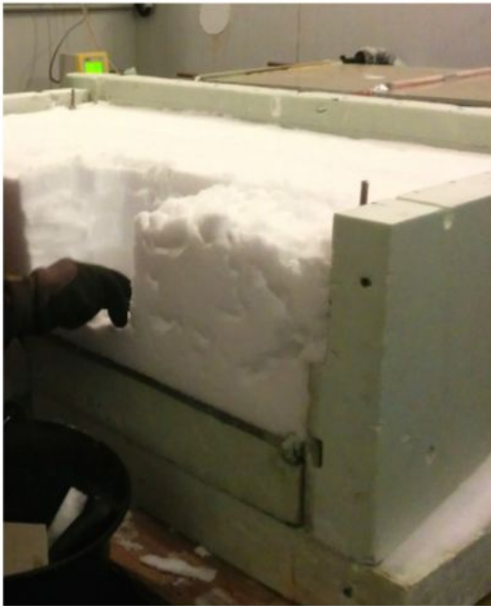
Panneau latérale enlevé pour mesurer densité et SSA
